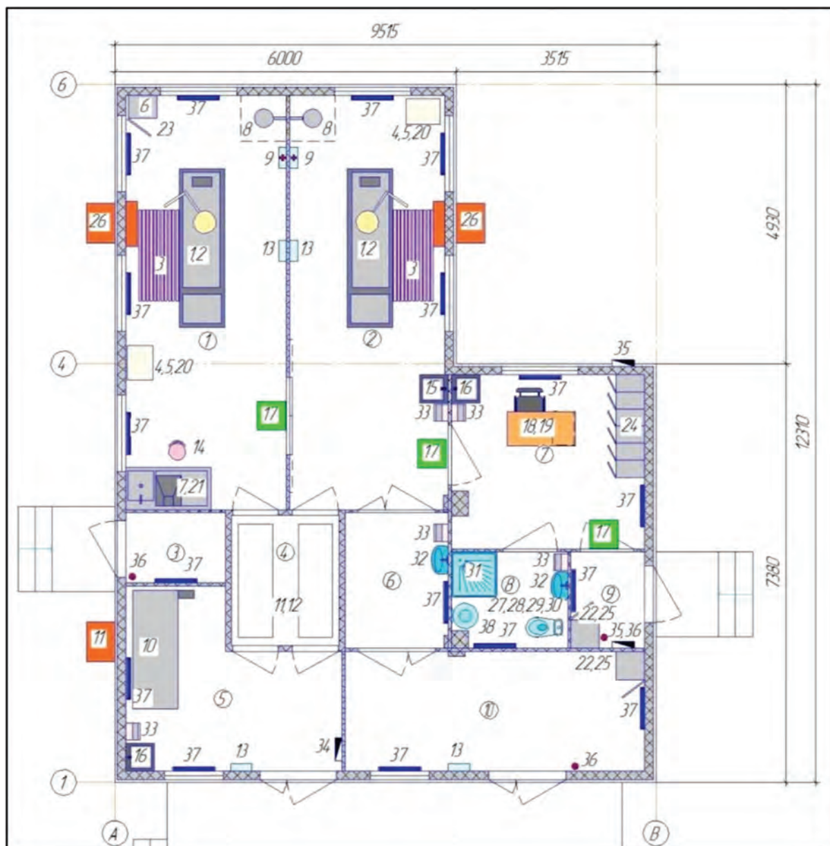
Рис. 2. Рекомендованный типовый план модульного здания, предназначенного для исследования инфицированных умерших (или с подозрением на их инфицирование).
