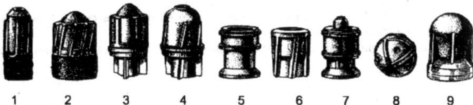
**Рис. 47.** Конструктивные особенности пуль к гладкоствольному огнестрельному оружию: 1 – Бреннеке 32-го калибра, 2 – Бреннеке 12 калибра, 3 – Ильина, 4 – Якана, 5 – «Идеал», 6 – Дважды турбинная Майера, 7 – БС, 8 – Круглая с центрирующими поясками типа «Спутник», 9 – «Вятка»
