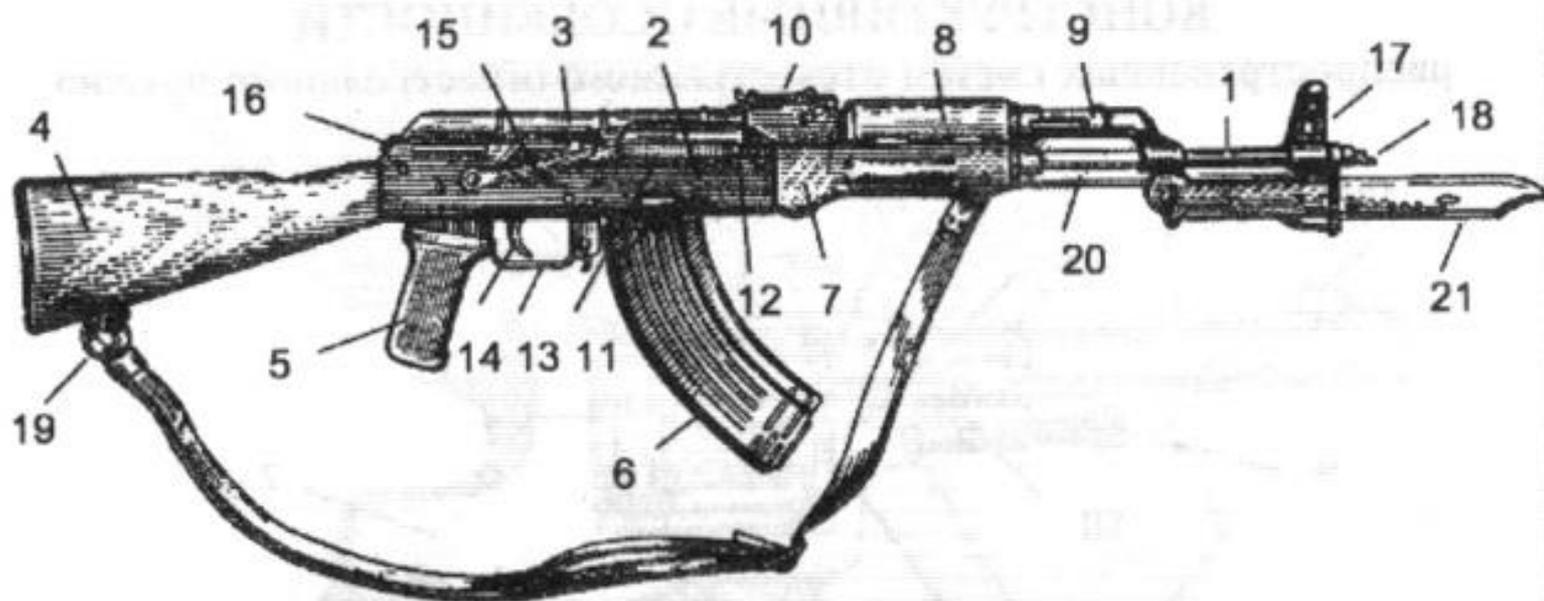
Рис. 19. Автомат АК-47 калибра 7,62 мм :
