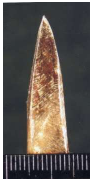
Рисунки 2. Плотницкий топор № 1 отечественного производства: клин топора (слева) и угол заточки клина топора (справа)
