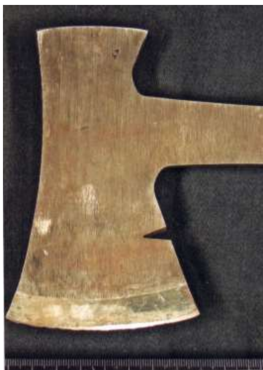
Рисунки4. Туристический топор №2 отечественного производства: клин топора (слева) и угол заточки клина топора (справа)
